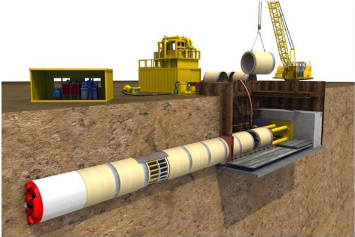
Figura 2-A : Tecnica di posa condotte con microtunnelling
